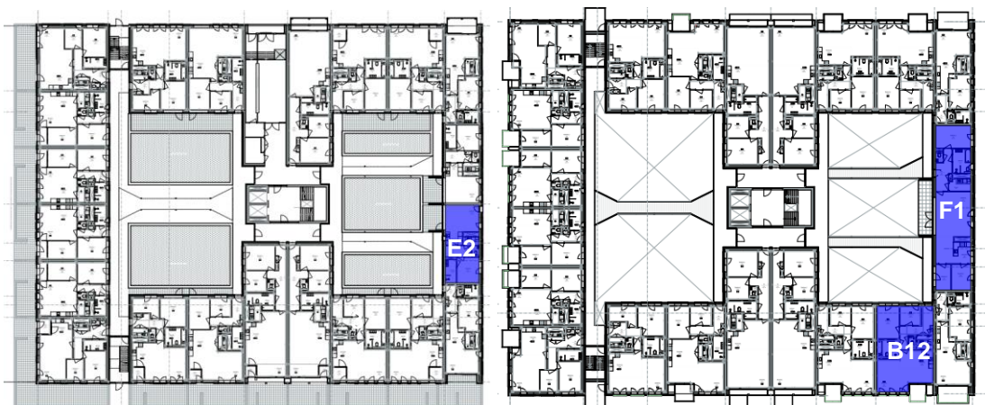
Figuur 4.1: Berekende appartementen t.b.v. de ventilatiebalans
